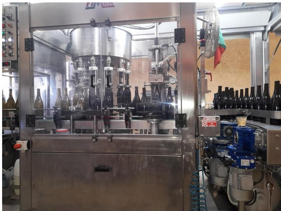
Chaîne mobile d'embouteillage
