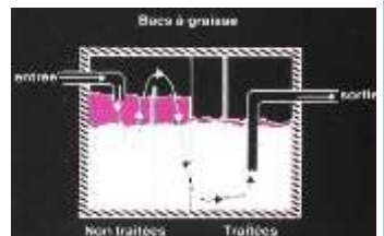
BACS A GRAISSE A gauche non traité, formation de croûte, pas d'air, mauvaises odeurs. A droite, bac à graisse traité, pas de croûte dure, bonne vie biologique, pas d'odeurs, espacement ou élimination des pompages.
